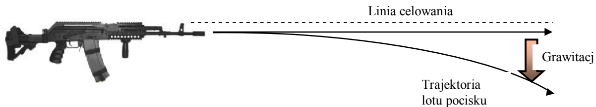
Rys. 30. Grawitacja powoduje odchylenie toru lotu pocisku ku dołowi.
