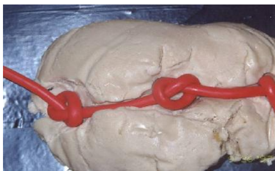
Rys. 51. Plastyczny materiał wybuchowy uzbrojony lontem detonującym .
