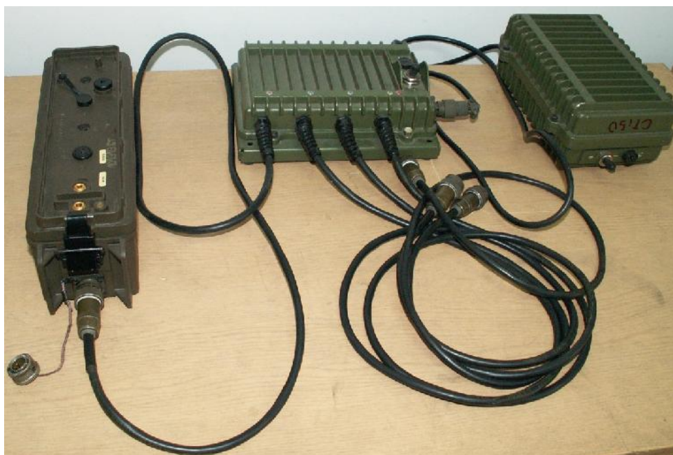
Rys. 101. Zasilacz akumulatorowy podłączony do ładowarki
