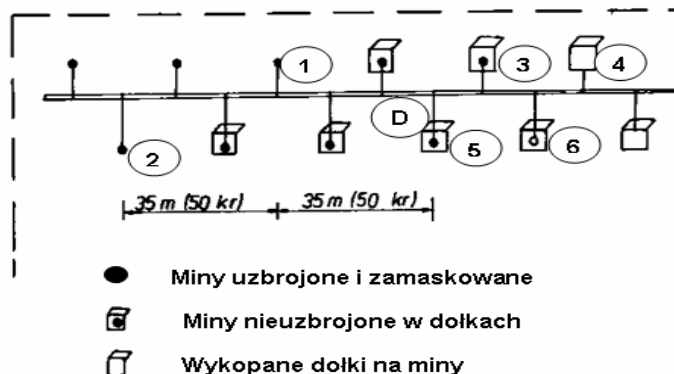
Rys. 72. Organizacja pracy drużyny podczas zakładania przeciwpancerneho pola minowego za pomocą taśmy minerskiej rozwijanej równoległe do frontu pola minowego.
