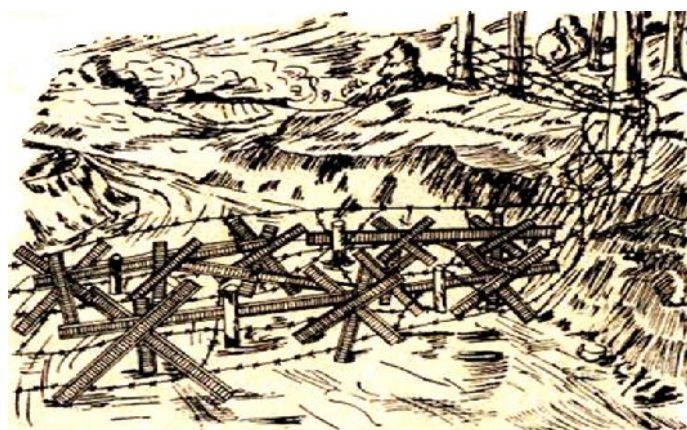
Rys. 84. Zapora z jeży metalowych
