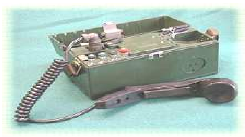
Fot. 67. Polowy aparat telefoniczny AP-82/MB-CB.
