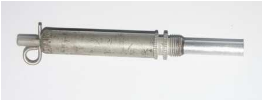
Fot. 130. Zapalnik o działaniu odciągowym do miny MON-100 składający się z : mechanizmu uderzeniowego MUW z i zapątu MD-5M.
