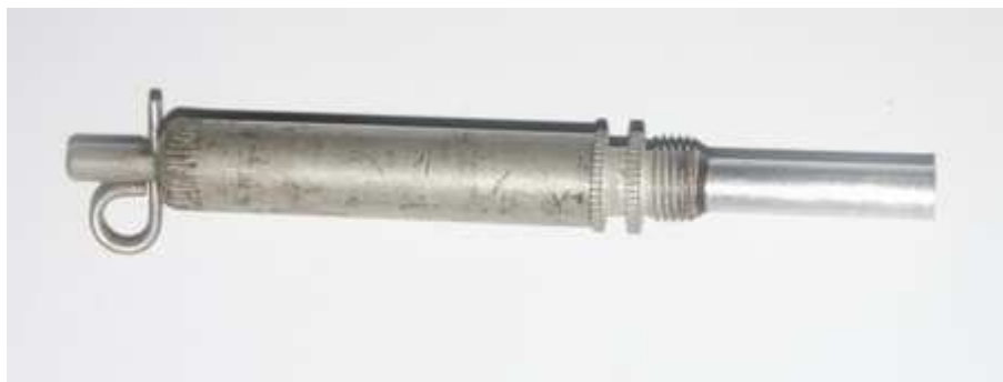
Fot. 117 Zapalnik o działaniu odciągowym do miny POMZ-2M składający się z : mechanizmu uderzeniowego MUW z i zapalnika MD-5M.
