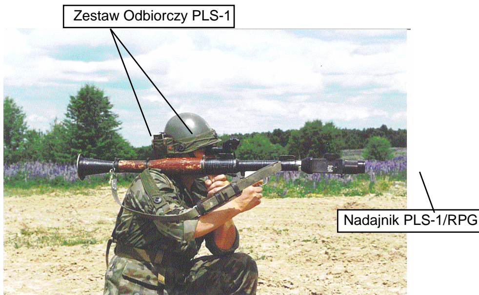
Fot. 34. Żołnierz wyposażony w zestaw symulatora PLS-1/RPG.
